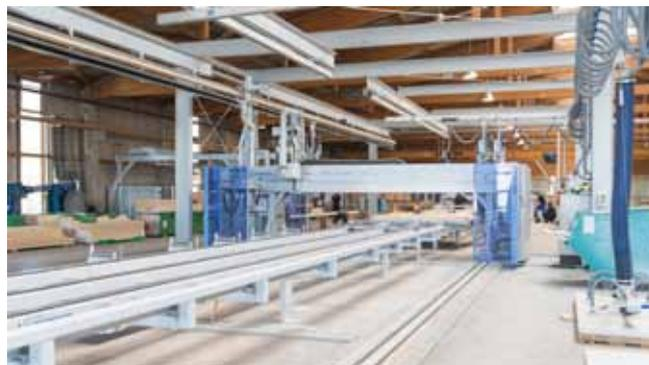
zeugmagazin. Damit ist es möglich, auch komplizierteste Bearbeitungen an Balken und Platten durchzuführen und wir sind für jegliche Anforderungen im Abbund, Riegelbau und Ingenieurholzbau gerüstet.
